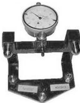
Rys. 6. Przyrząd do pomiaru płaskich miejsc
